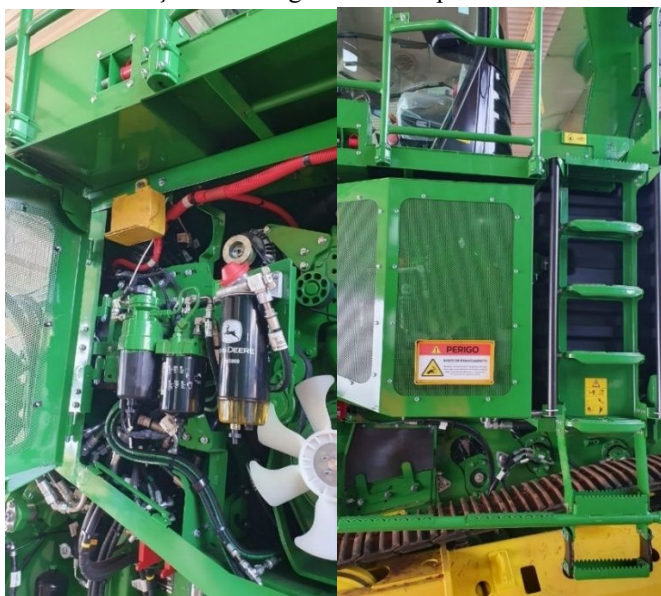
Figura 21 - Padronização das mangueiras e componentes hidráulicos
