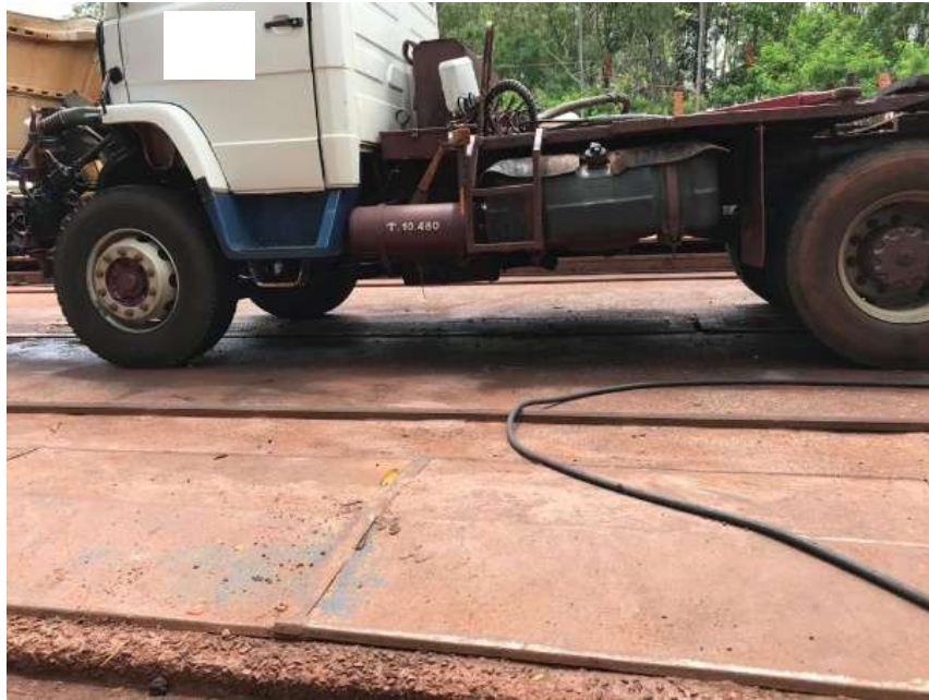
Figura 22. Dificuldade ergonômica para lavagem inferior do caminhão
