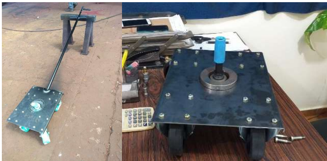
Figura 25. Dispositivo final de lavagem desenvolvido via prototipagem
