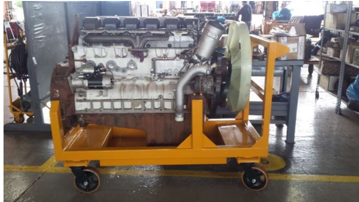
Figura 21. Protótipo do suporte de armazenamento e transporte do motor
