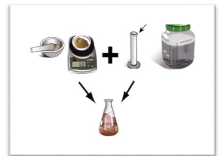
6º passo – Dissolução do solo com NaOH 1%
