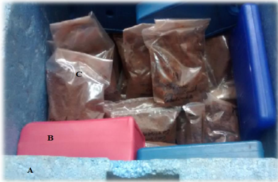
Figura 18 - Coleta de amostra do solo para as análises microbiológicas, sendo caixa de isopor (A); gelox (B) e amostras (C).
