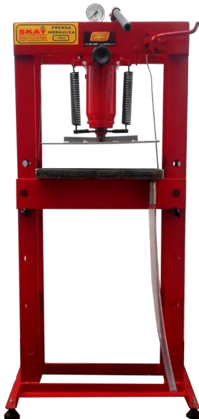
Figura 2 - Prensa Hidráulica, utilizada para eliminação de H 2 O da membrana de CB.
